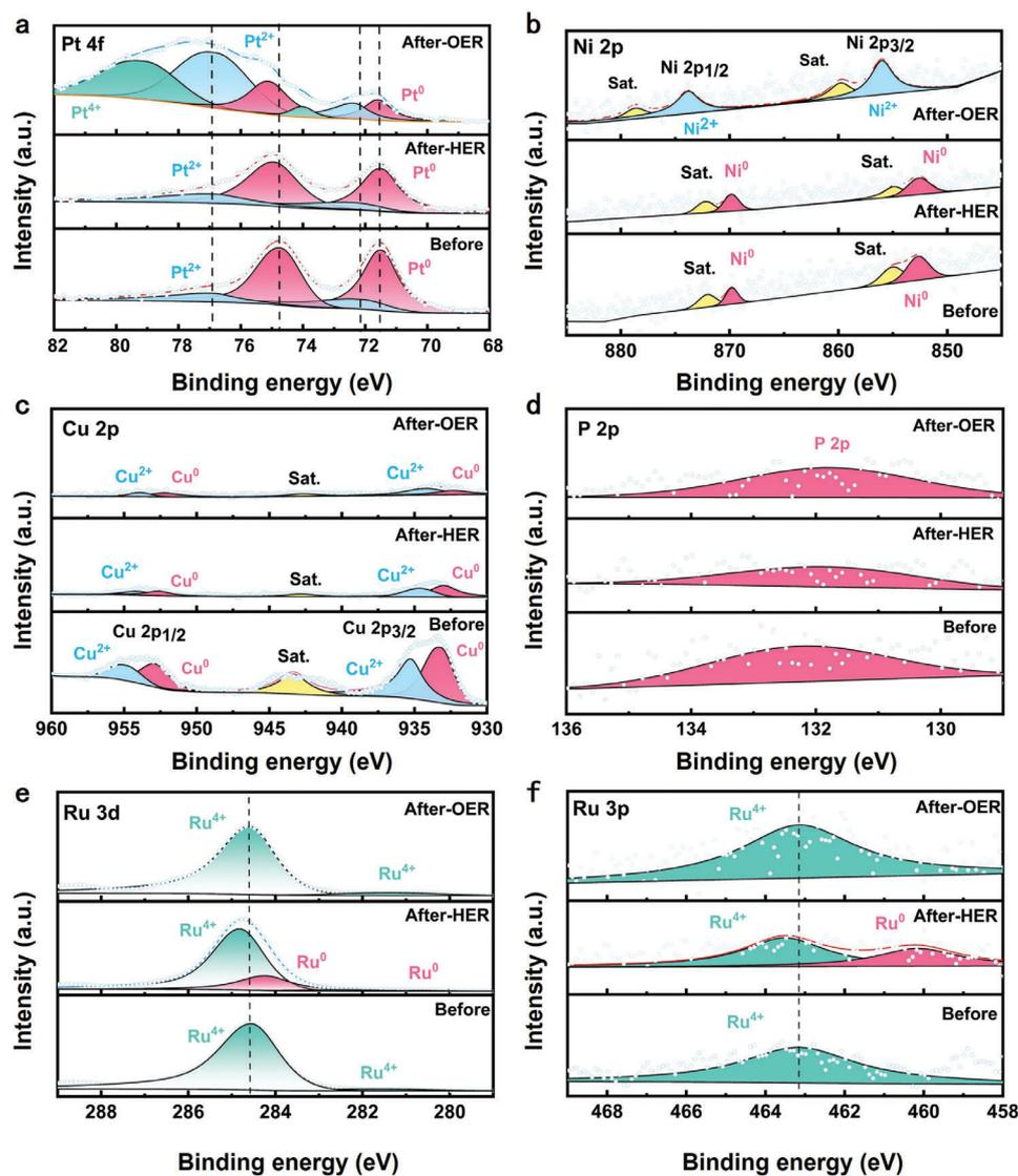
Figure 3. Surface characterization of NPMG@RuO<sub>2</sub>: XPS. a) Pt 4f. b) Ni 2p. c) Cu 2p. d) P 2p. e) Ru 3d. f) Ru 3p.
