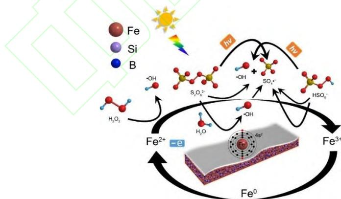
酸性条件下 Fe-Si-B 非晶合金条带活化过氧化氢及过硫酸盐产生自由基的机理<sup>[33]</sup>
