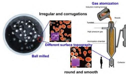
球磨法和气体雾化法制备非晶合金粉末<sup>[4, 15]</sup>
