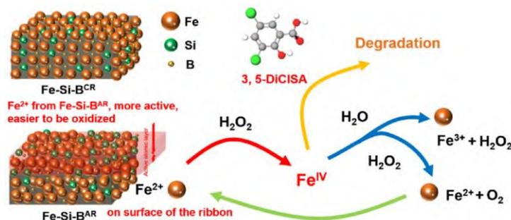
中性条件下 Fe-Si-B 非晶合金条带活化过氧化氢产生高价铁 Fe(IV)的机理<sup>[31]</sup>
