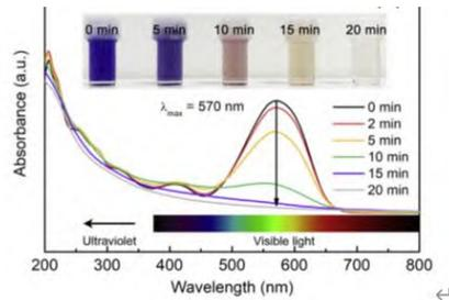
图 2 有机染料分子的降解过程及对应吸收光谱变化<sup>[18]</sup>
