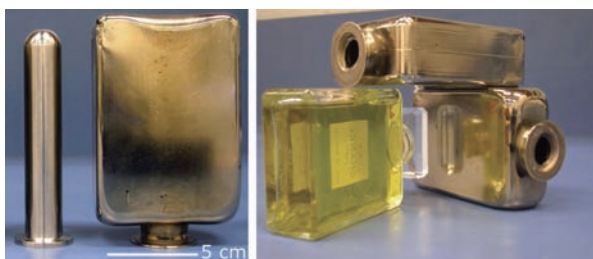
图5 \text{Zr}_{44}\text{Ti}_{11}\text{Cu}_{10}\text{Ni}_{10}\text{Be}_{25} 金属玻璃通过吹塑成型制得的容器 [23]
